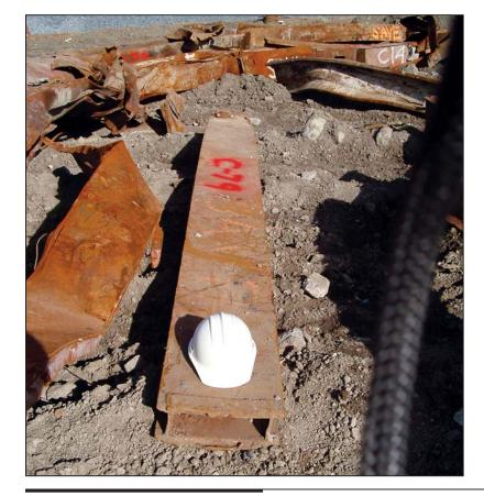
Figure D-13 WTC 1 or WTC 2 core column (C-74).
