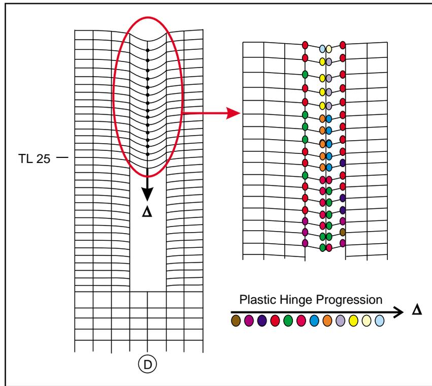
Figure 3.8. Progression of plastic hinge formation in DS1
